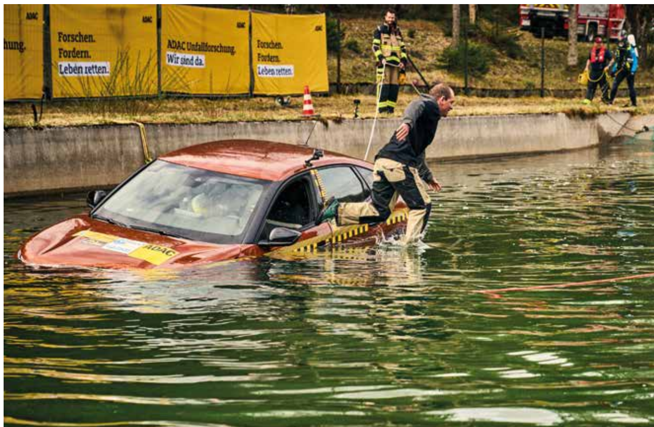
Der TCS testete das Verhalten eines Verbrenner-Autos und einem Elektrofahrzeug beim Eintauchen ins Wasser. (Bilder: TCS)
